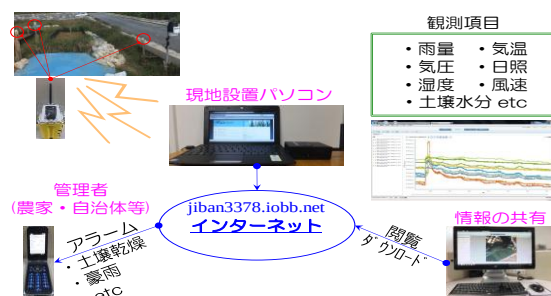
図-5 情報共有型モニタリングシステム
