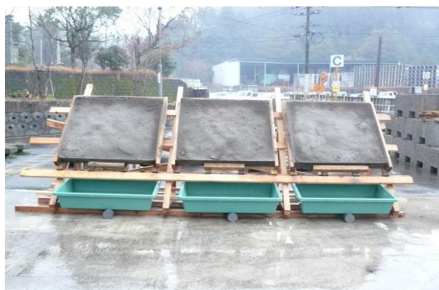
写真-2 低強度モルタル屋外暴露状況
