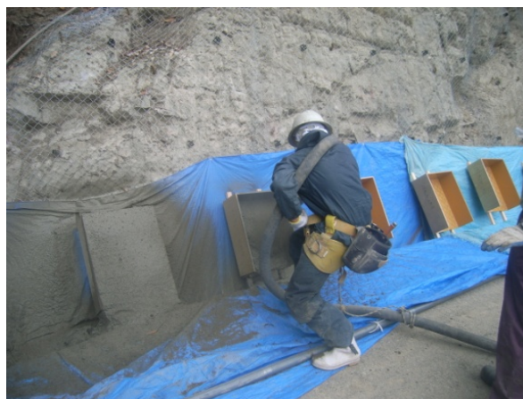
写真1. 供試体作成状況
