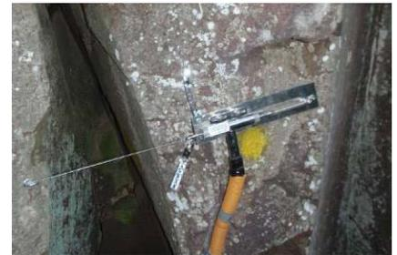
写真-2 変位計設置状況
