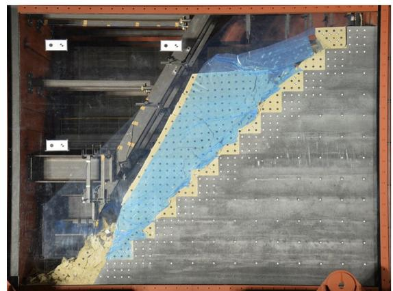
図4 三層斜面模型崩壊状況
