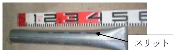
図3 加工した排水パイプ
