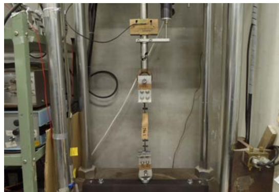
写真 4 引張試験状況
