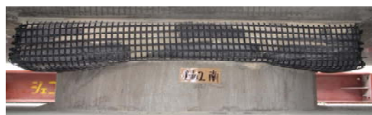
写真 2 ジオテキスタイル土のう (試験前)
