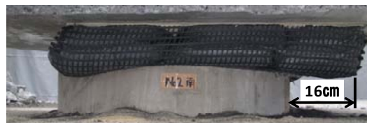
写真 3 ジオテキスタイル土のう (試験後)
