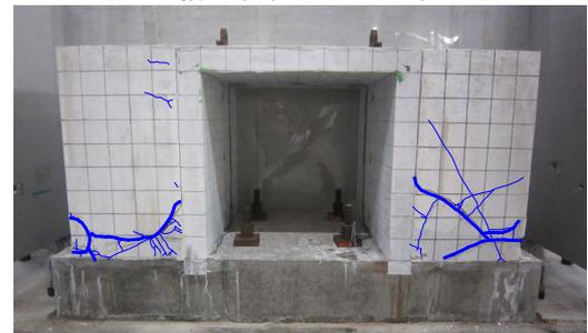
写真-2 固化改良体のひびわれ状況
