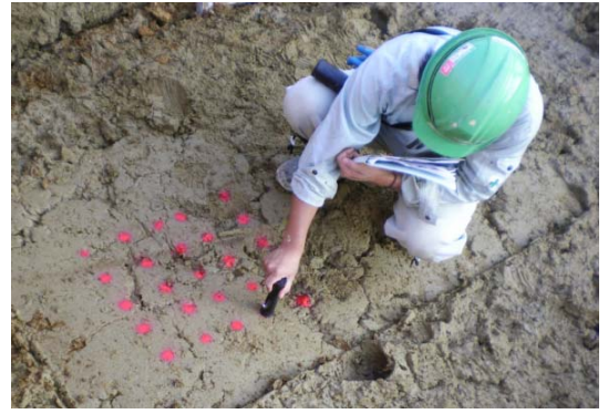
写真-1 短期強度測定状況（地表面）
