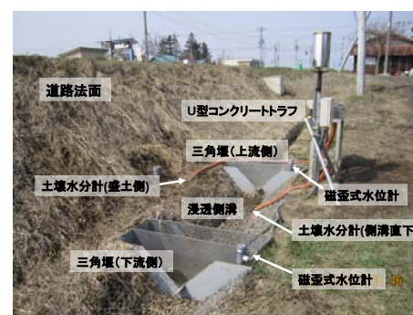
写真-1 現場浸透率試験装置の設置状況
