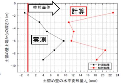
図4 実計測/解析結果比較
