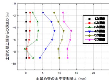
図5 ステップ解析結果 (アンカー抵抗考慮)
