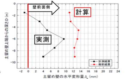
図6 実計測/解析結果比較 (アンカー抵抗考慮)
