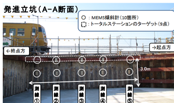
図 2 現場略図・計測機器の配置状況
