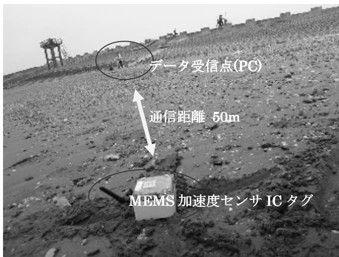
図-5 加速度センサ IC タグの設置状況
