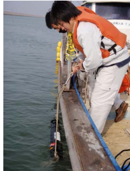
写真-1 LISST-100Xによる観測の状況
