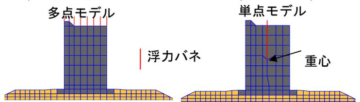
図.1 浮力のモデル化
