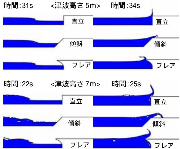
図4 津波進行の様子
