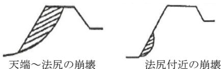
図2 完全欠壊(左)と部分欠壊(右)
