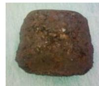
図 2 鉄イオン発生材(D材)
