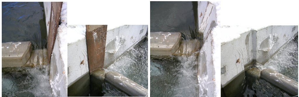
ケース1 側壁凹部の蓋板有り 側壁沿いの安定した越流水脈 ケース2 側壁凹部の蓋板無し 側壁凹部により跳ね返る越流水脈
