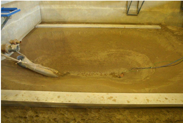
b) 排砂後(排水後)の状況
