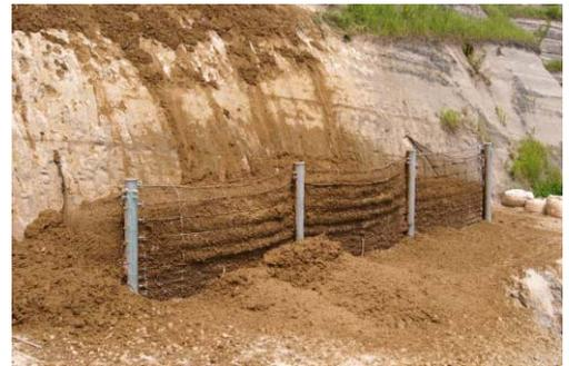
写真-3 実験 Case1 の 3 回目土砂流下状況
