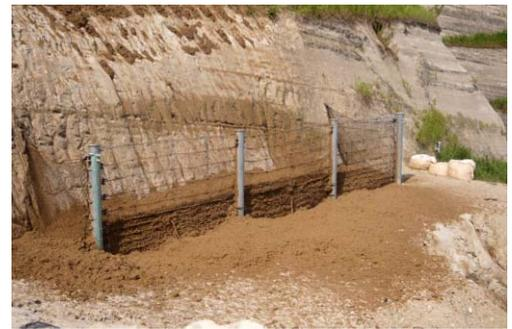
写真-2 実験 Case1 の 1 回目土砂流下状況
