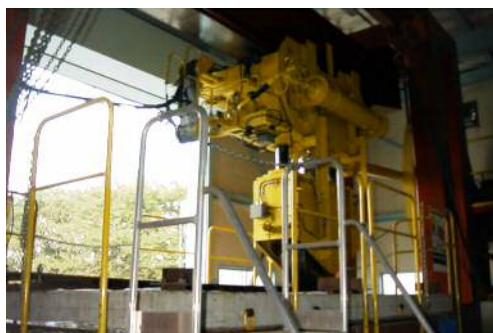
写真 1 輪荷重移動載荷試験機
