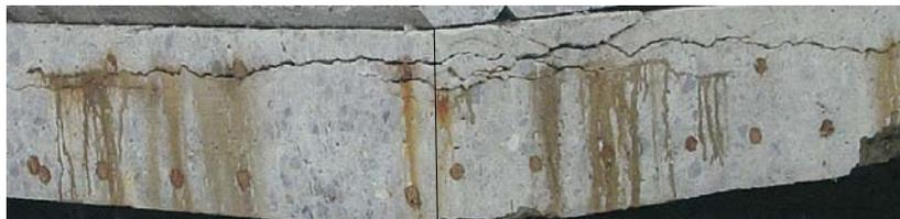
写真-1 観察された水平ひび割れ (錆汁は切断後に発生)
