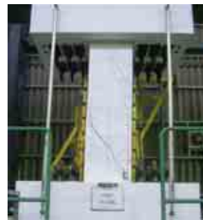
写-3 せん断破壊直後 (PW02、+14/1000)
