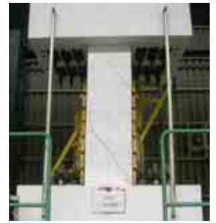
写-4 層間変位 2.0% (PW02、+20/1000)
