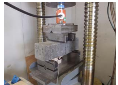
写真-4 曲げタフネス試験状況
