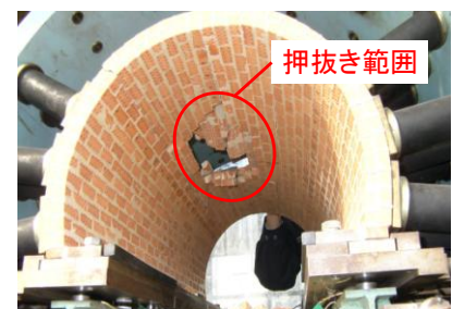
写真-4 Case1の破壊状況(実験終了時)
