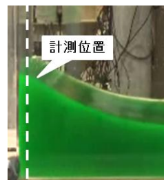
写真-1 波高計測位置
