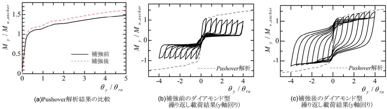
図-6 アンカー部の基部回転角とモーメントの関係
