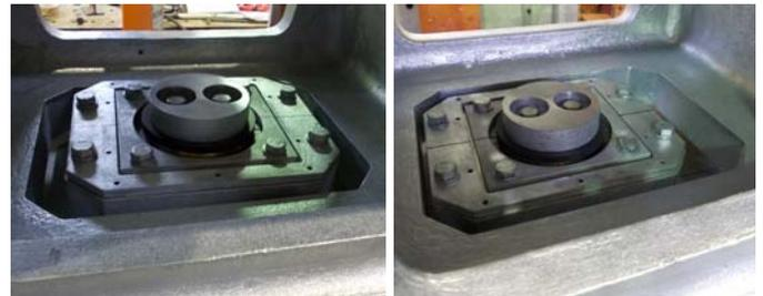
(a)中立位置(試験前) (b)橋軸・橋直移動後
