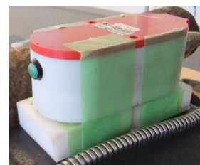
図-1 パルス型渦電流板厚測定器 (左：測定器 右：プローブ)
