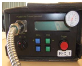
図-1 パルス型渦電流板厚測定器 (左：測定器 右：プローブ)
