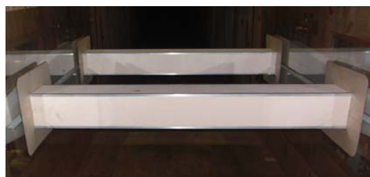
図-1 風洞内タンデム角柱設置状況 ( s=3.5 )
