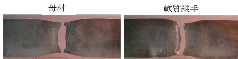
写真2 破断後の試験体
