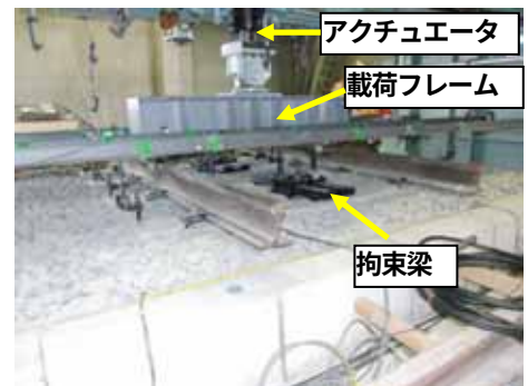
図5 繰返し載荷試験の状況
