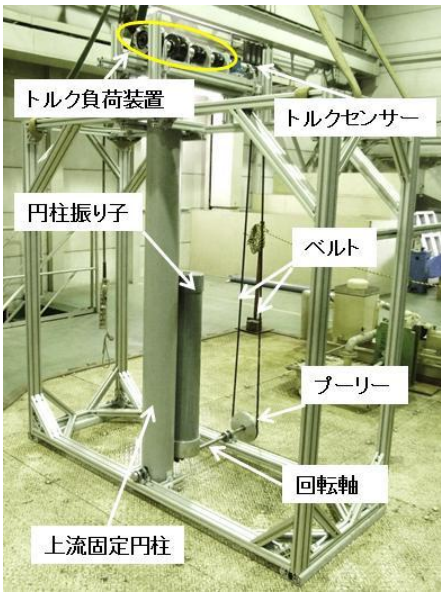
Fig.1 実験装置の概略
