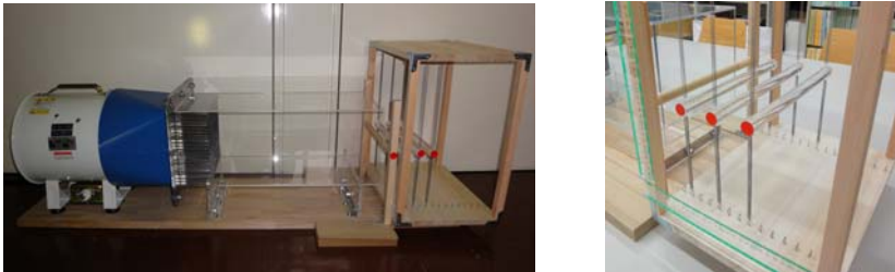
図 1 実験装置：(左) 装置全体；(右) 固定円柱およびバネ支持された 3 本の円柱
