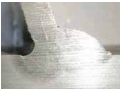
写真1 TIG再溶融による溶接ルート部の改善状況
