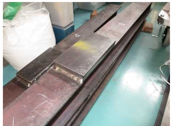
写真-2 試験体の溶接部(試験体5)
