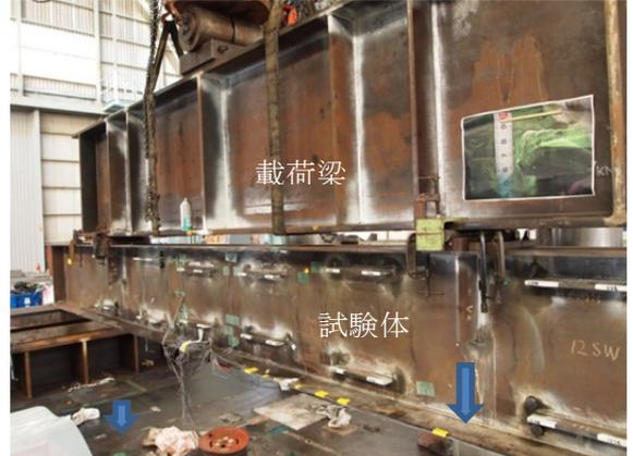
写真-1 溶接継手桁疲労試験
