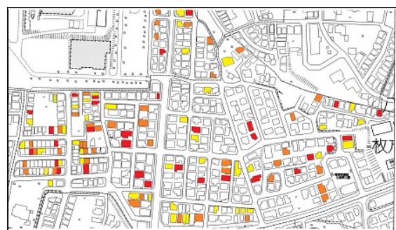
図-2 建物の倒壊危険度区分
