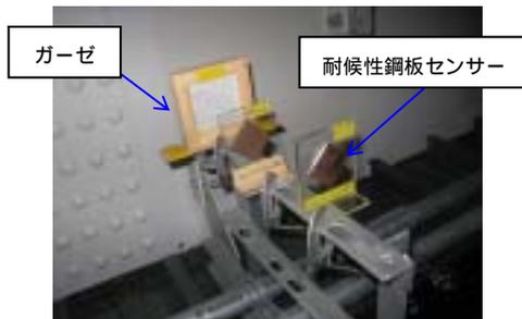
写真-2 鋼桁間の機器設置状況
