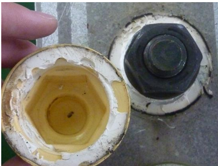
写真. 防錆キャップと内部ボルトの状況（左：亜熱帯 10 年暴露後、右：干満帯 4 年暴露後）
