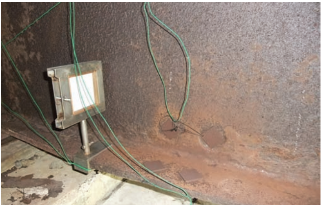
写真-3 試験片とガーゼ式捕捉器（3ヶ月後）
