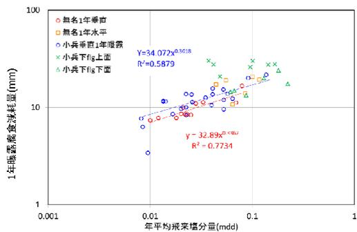
図4 年平均飛来塩分と腐食減耗量の関係
