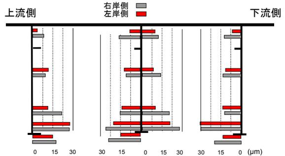
図3 1年曝露試験片腐食減耗量
