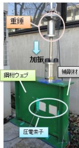
図4 加振試験の概要
