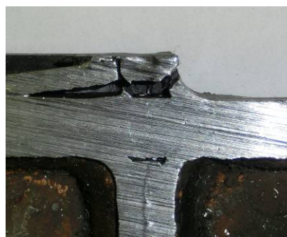
図-6 き裂進展箇所近傍の断面 (S30-8-5-R-VC-MD)
