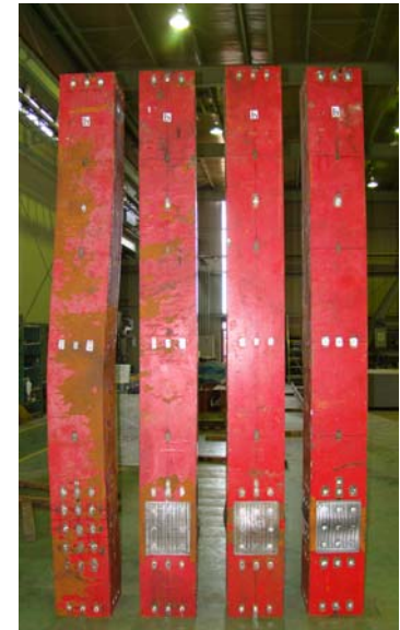
写真 2 試験体の全体変形 (b 面側から撮影)
