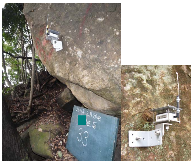
図-4 センサの設置状況の一例
