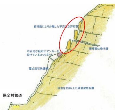
図-3 研究対象斜面の代表的な断面
