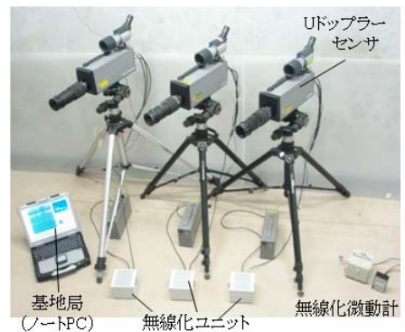
図 3 多点/多次元計測システム
