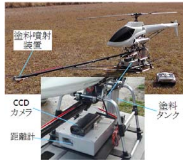
図7 遠隔制御式反射ターゲット形成装置
