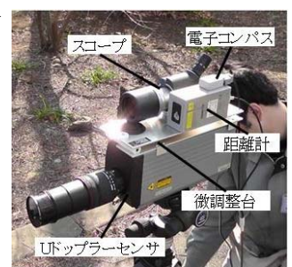
図 5 距離・方位測定装置
