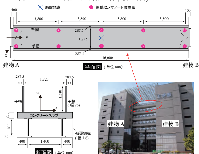
図-2 加速度の計測対象とセンサ配置図
